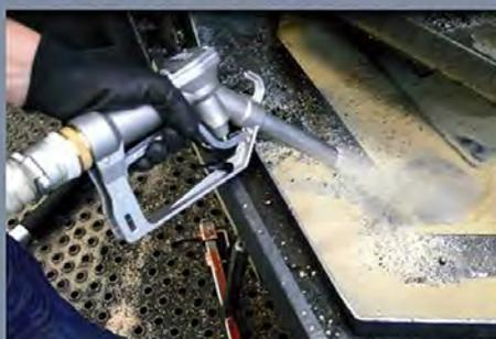
Bac extractible pour l'élimination des copeaux métalliques. Alternative: trémie basculante intégrée.
