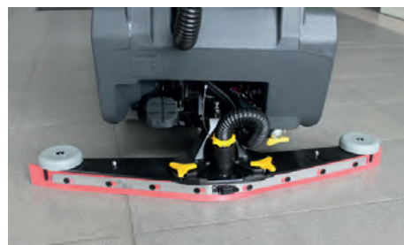
Suceur réglable avec lamelles en polyuréthane
